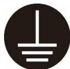
アース工事は、電気設備基準など関連する法令、規則などに従って必ず「法的有資格者」による D 種接地工事を行ってください。
